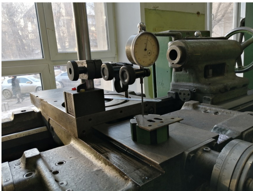
Рис. 3. Устройство для измерения износа режущих сегментов
