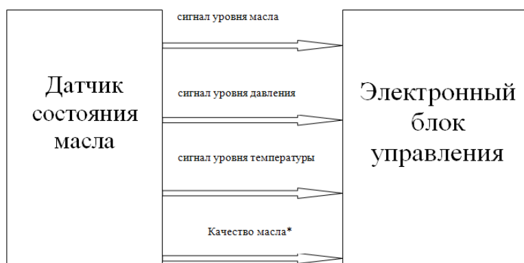
Рис. 2. Структурная схема работы датчика состояния масла
